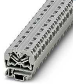
30 А, проходной блок зажимов, боковой кабельный ввод, 4 разъема
