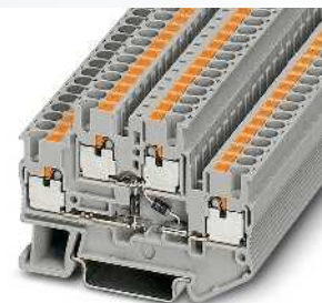
0,5 А, диодная двухъярусная клемма, 1N 4007 (1300 В/0,5 А)
