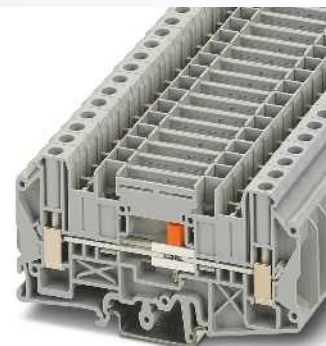
50 А, разделит. клемма измерит. преобразователя, 4 отв. для вставных перемычек, 2 отв. для винтовых перемычек
