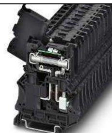
10 А, клемма рычажного предохранителя для стеклянных предохранителей 6,3 x 32 мм, со световой индикацией
