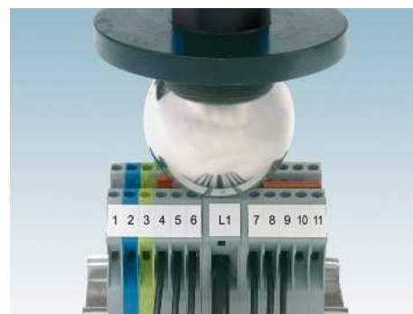
Контрольный шар диаметром 50 мм
